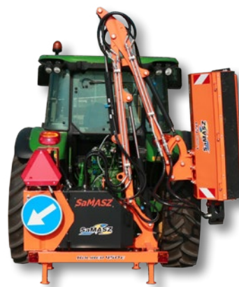
Pozycja transportowa - widoczny zderzak tylny ze światłami.
