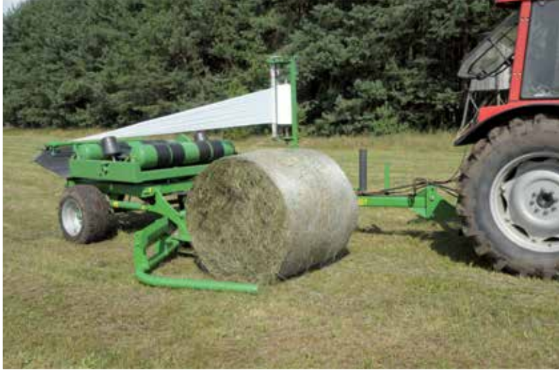
Załadunek czołowy z podjazdem do boku beli
