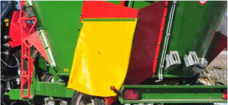
VMP-10S – okna wysypowe z rynnami i osłonami
