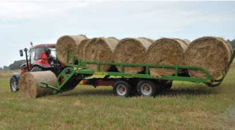
Szeroka platforma ładunkowa (2550 mm) umożliwia załadunek bel w dwóch rzędach
