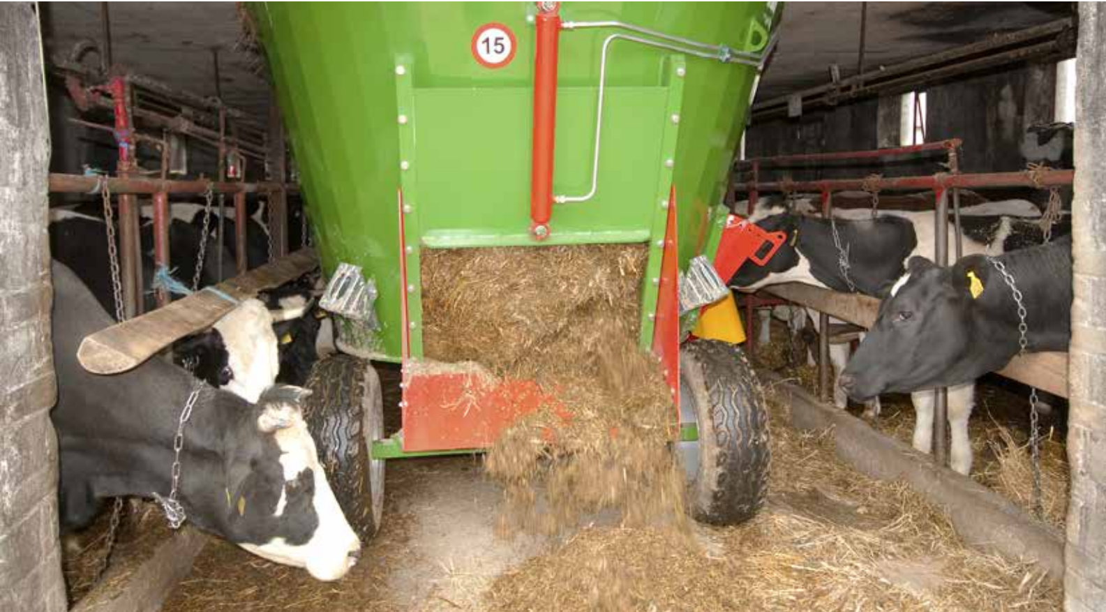
PRONAR VMP-5ST – dwa okna wysypowe z rynnami: boczne okno z przodu z prawej strony i tylne okno (na zdjęciu)
