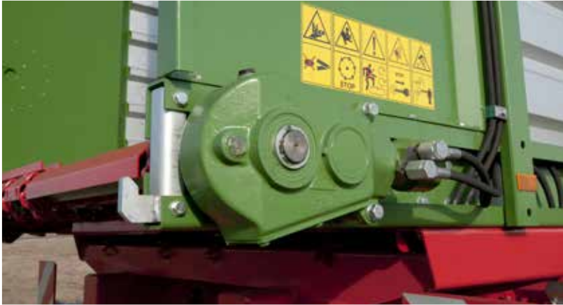
Podpora dyszla prosta, mechaniczna, teleskopowa
