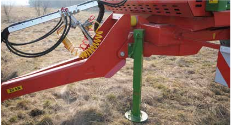
Podpora dyszla prosta, mechaniczna, teleskopowa
