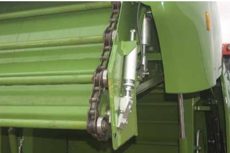
Łańcuch rolujący pozwala na uzyskanie wysokiego stopnia sprasowania materiału
