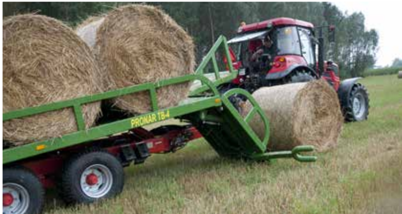
Prosty system rozmieszczenia bel na platformie ładunkowej
