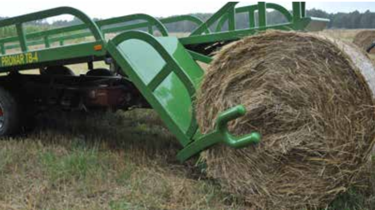
Szeroka platforma ładunkowa (2550 mm) umożliwia załadunek bel w dwóch rzędach
