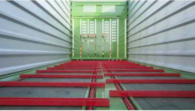
Płyta podłogowa drewniana z metalowymi prowadnicami łańcuchów przenośnika
