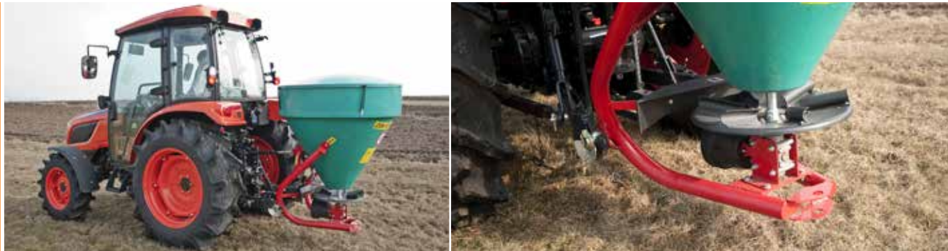
Rozsiewacz PRONAR FD1-M05 o pojemności 500 dm³
