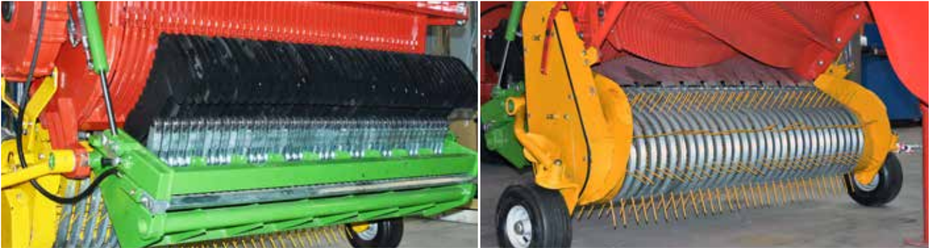
Podbieracz krzywkowy z ośmioma rzędami palców podbierających z rolką i skrętnymi kołami kopiującymi
