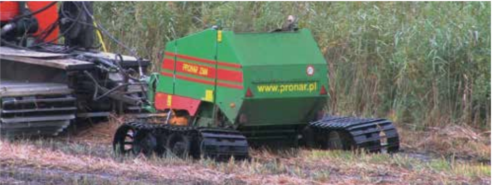
Prasa PRONAR Z500KG - gąsienicowy układ jezdny pozwala pracować na podmokłych i bagiennych terenach
