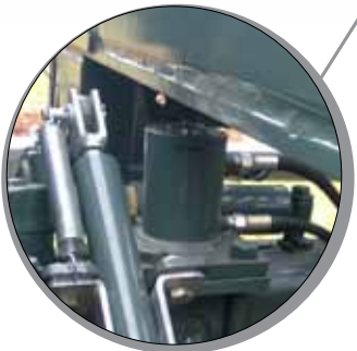
Hydrauliczna blokada zawieszenia
