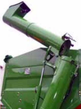
Dwusegmentowy przenośnik ślimakowy przedni rozkładany hydraulicznie
