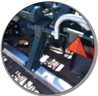
Zderzak tylny wysuwany hydraulicznie
