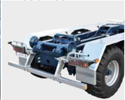
Zderzak tylny wysuwany hydraulicznie
