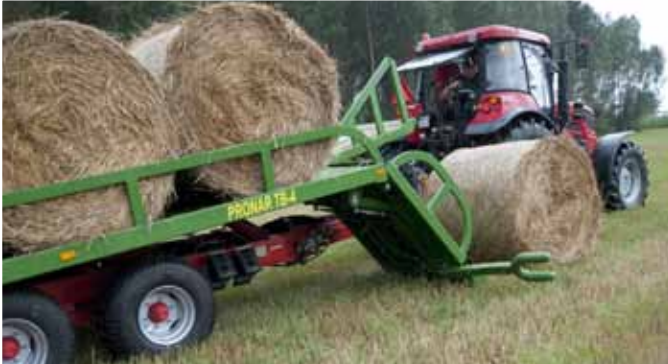
Prosty system rozmieszczenia bel na platformie ładunkowej
