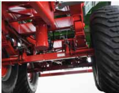
Mocne i solidne podwozie na resorach parabolicznych ułatwia transport w trudnym terenie
