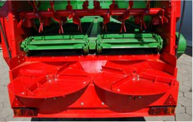
Rozrzutnik PRONAR N262/1 - Adapter AH20 z dwoma szeroko rozrzucającymi, wyważonymi talerzami
