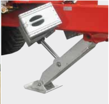
Hydrauliczna nożycowa podpora
