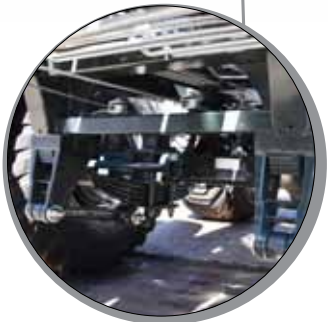
Zawieszenie tandem na resorach parabolicznych
