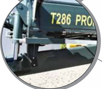
Dyszel amortyzowany hydraulicznie
