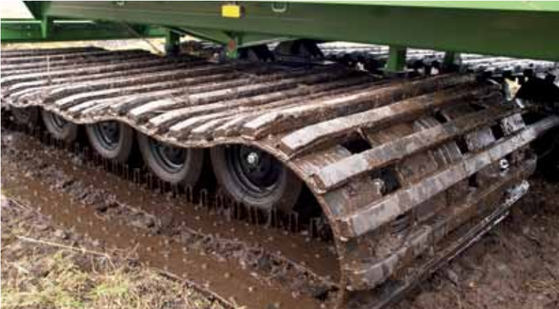
Gąsienice z nakładkami wymiennymi gumowymi
