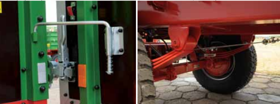
Blokada burty portalowej zabezpieczająca przed samoczynnym zamykaniem i uszkodzeniem
