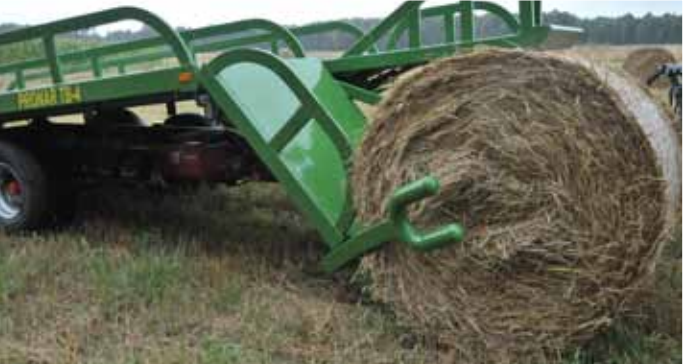
Szeroka platforma ładunkowa (2550 mm) umożliwia załadunek bel w dwóch rzędach
