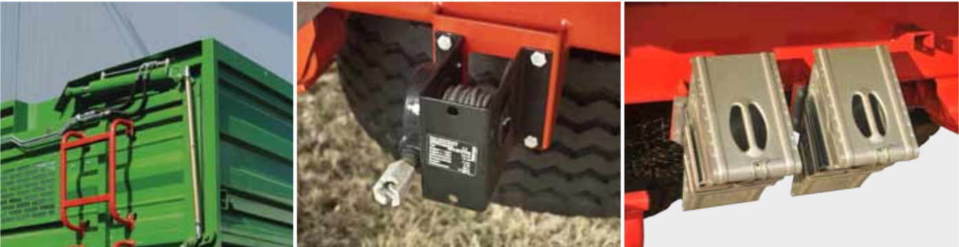
Blokada burty portalowej zabezpieczająca przed samoczynnym zamykaniem i uszkodzeniem
