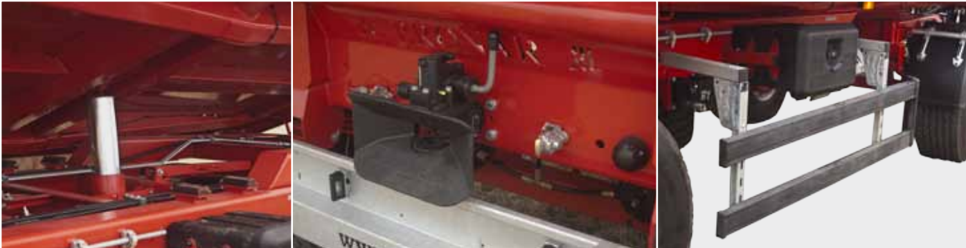
Teleskopowy siłownik wywrótu skrzyni ładunkowej z zawieszem przegubowym
