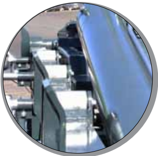
Rama podwozia o wysokiej wytrzymałości z rolkami podpierającymi kontener
