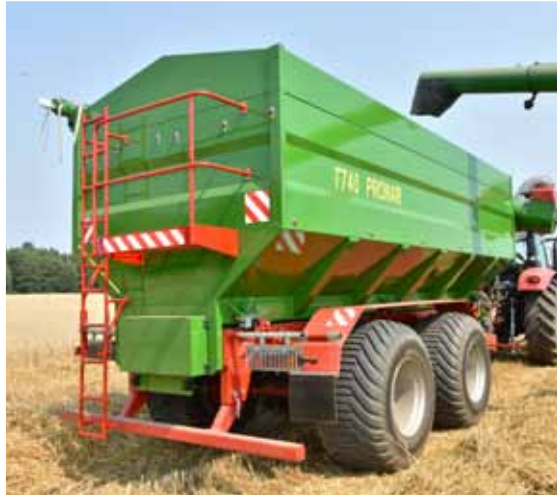
Balkon i składana drabinka na ścianie tylnej skrzyni ładunkowej
