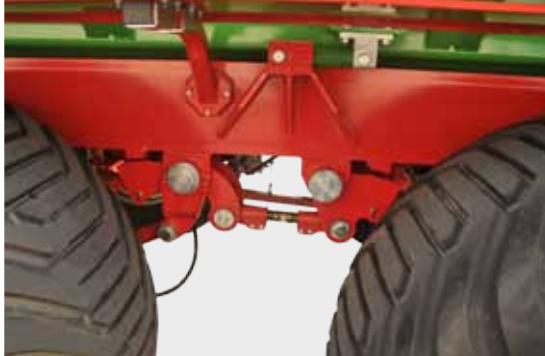
Zawieszenie na resorach parabolicznych
