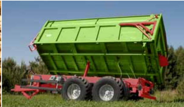
Wywrot na prawą stronę pod kątem 45° w T669/1
