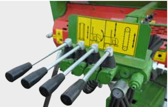
Rozrzutnik PRONAR N262/1 - hydrauliczny napęd przenośnika
