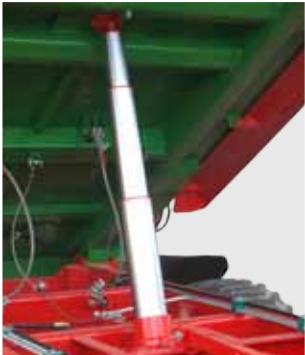
Teleskopowy siłownik wywrotu skrzyni ładunkowej z zawieszem przegubowym
