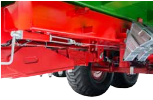
Dyszel resorowany resorem stalowym
