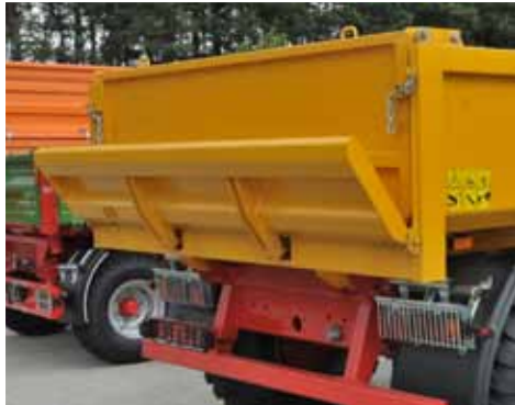
Hydrauliczna klapa tylna uchylana do dołu.
