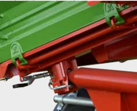
System wywrotu trzystronnego skrzyni z przegubami kulowymi tylnymi amortyzowanymi
