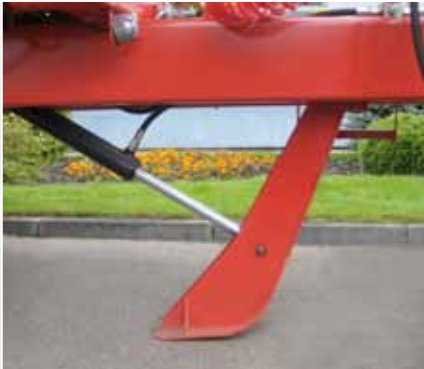
Hydrauliczna, nożycowa noga podporowa
