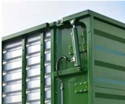
Ściana tylna podnoszona hydraulicznie, skrzynia przystosowana do montażu walców dozujących z napędem
