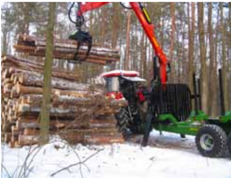
Hydrauliczne teleskopowe podpory ładowacza
