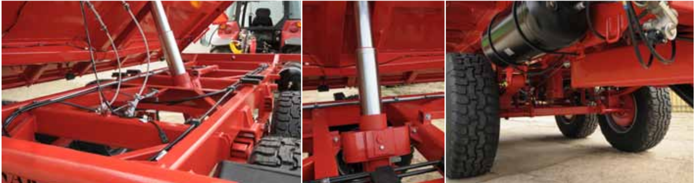
Rama podwozia z prostokątnych zamkniętych profili
