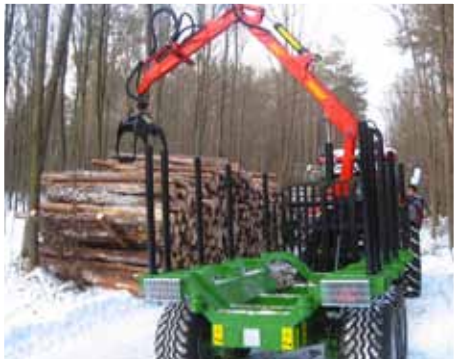
Wysuwana hydraulicznie tylna rama z poprzeczką i kłonicami
