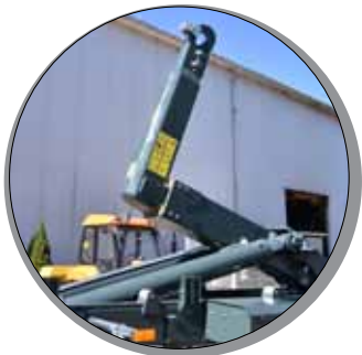
Podnoszenie realizowane dwoma siłownikami hydraulicznymi
