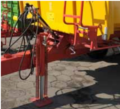
Dyszel amortyzowany resorem stalowym (T701)
