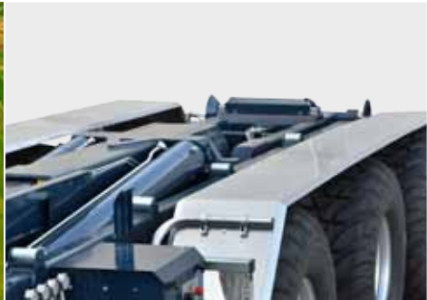
Stabilna rama z dwoma siłownikami hydraulicznymi
