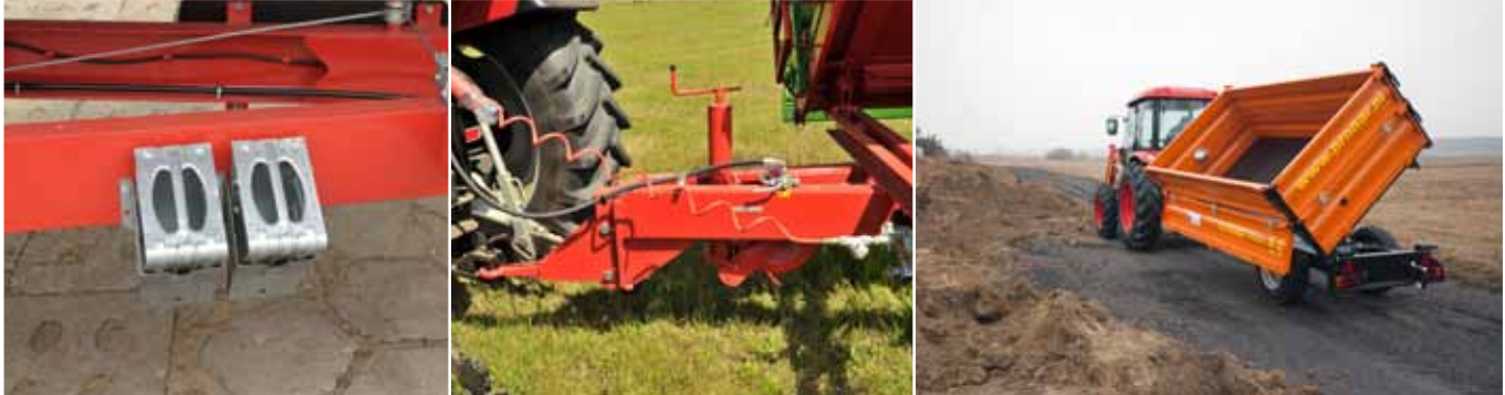
Klipy pod koła z kieszeniami w wyposażeniu standardowym i podpora serwisowa skrzyni ładunkowej Dyszel sztywny dołączenia z dolnymi zaczepami ciągnika System wywrotu trzystronnego skrzyni z przegubami kulowymi tylnymi o optymalnym rozstawie
