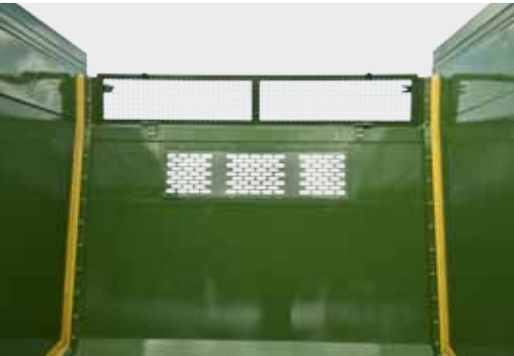
Uszczelniona ściana przesuwna
