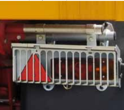
Kratki zabezpieczające na lampach
