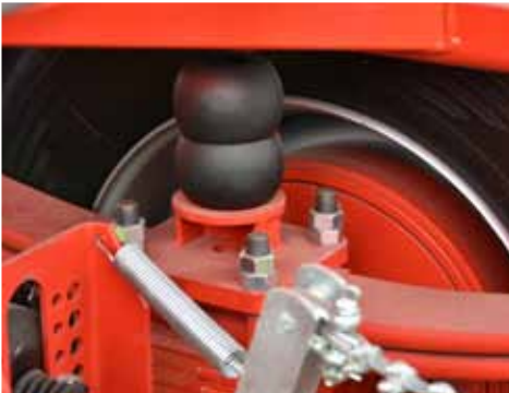
Zawieszenie na resorach parabolicznych z gumowymi amortyzatorami
