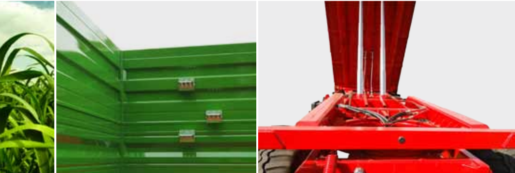
Dodatkowe okna zsyłowe w bocznej ścianie T780
