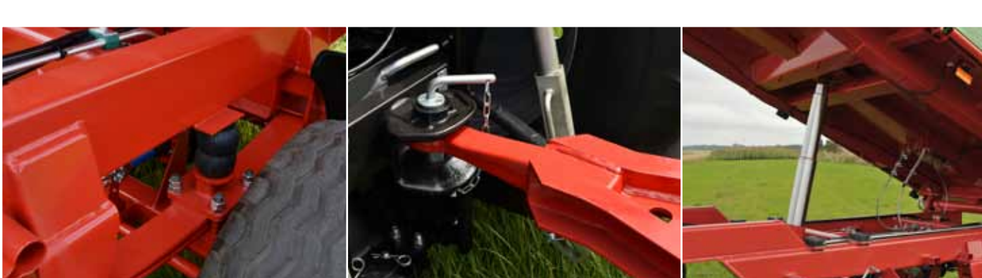
Zawieszenie z resorami parabolicznymi i odbojnikami gumowymi
