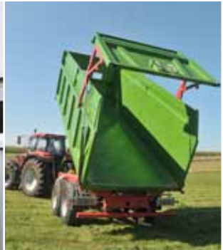
Wywrot do tyłu pod kątem 50°
