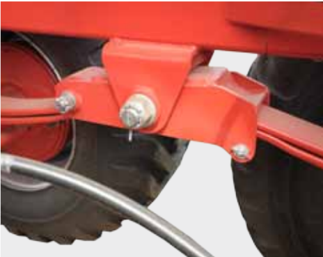
Zawieszenie tandem z resorami parabolicznymi wT679/2 i T701
