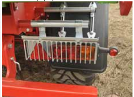
Tylne oświetlenie przyczepy jest zabezpieczone przed uszkodzeniami specjalnymi kratkami
