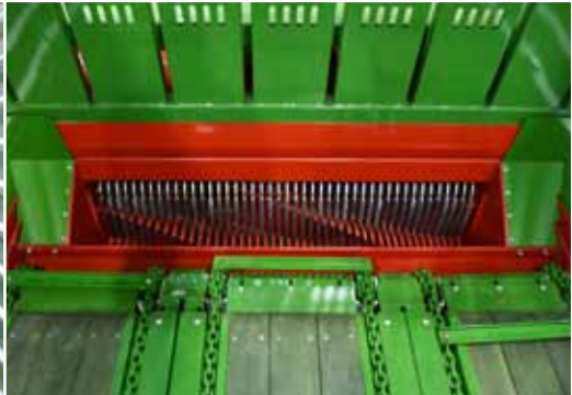
Rotor załadunkowy z trudnościeralnej blachy
