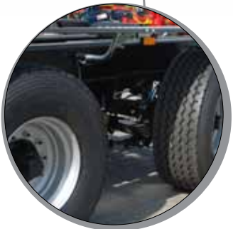
Zawieszenie z tylną osią skrętną kierowaną biernie
