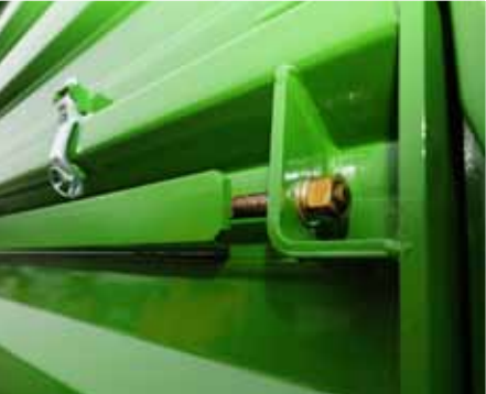
Listwowe wzmocnienie burt ścian bocznych
