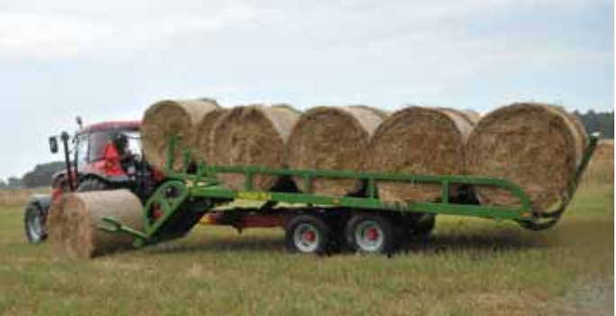
Szeroka platforma ładunkowa (2550 mm) umożliwia załadunek bel w dwóch rzędach
