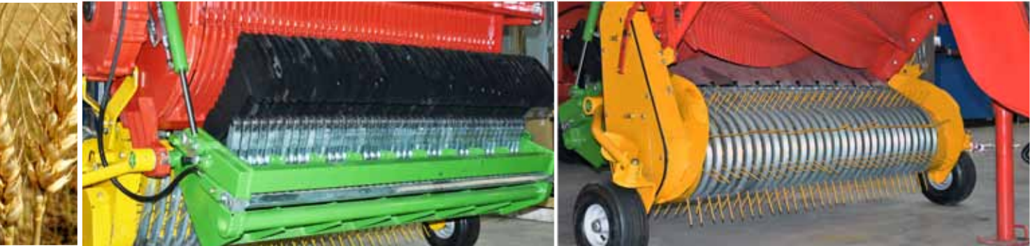
Podbieracz krzywkowy z ośmioma rzędami palców podbierających z rolką i skretnymi kołami kopiującymi
