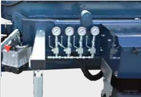
Układ hydrauliczny kierowania czynnego
