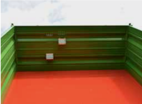
Skrzynia ładunkowa przystosowana do transportu europalet, ze wzmocnioną płytą podłogową
