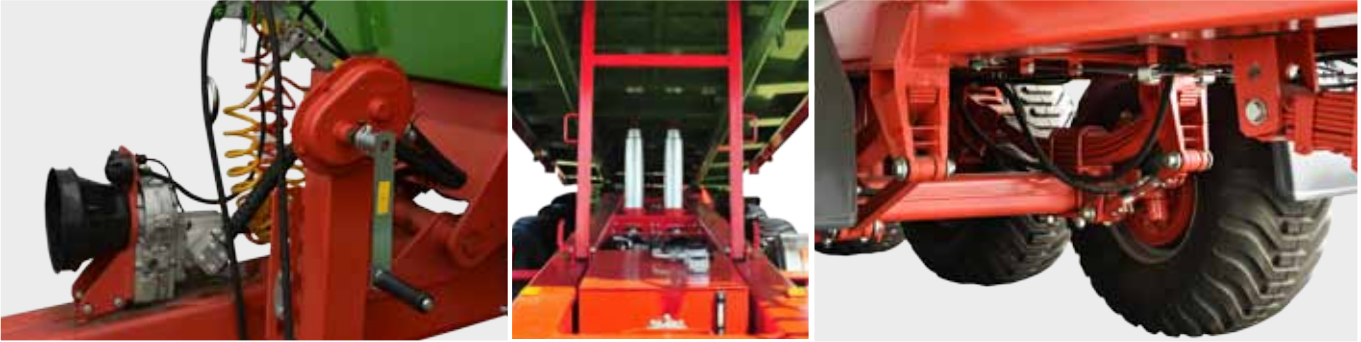
Podpora mechaniczna z przekładnią
