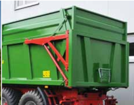
Hydrauliczny system unoszenia klapy tylnej
