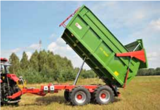
Wywrót do tyłu pod kątem 50°
